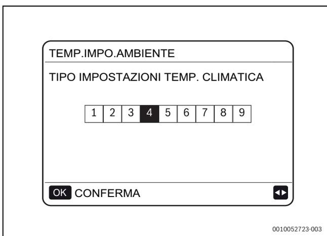
Fig. 185 Selezione delle curve climatiche
